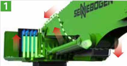
1 Ausleger senken, Gas komprimieren
