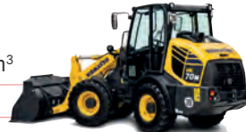
WA80M-8EO Betriebsgewicht 5,7 t; Schaufelvolumen 0,80 - 1,25 m 3
