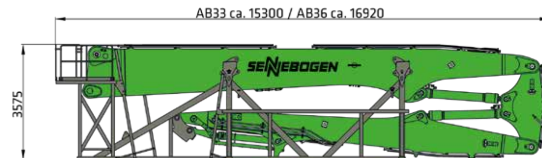
3-TEILIGER ABRUCH-AUSLEGER INKL. TRANSPORTGESTELL CA. 25 t BIS 28 t
