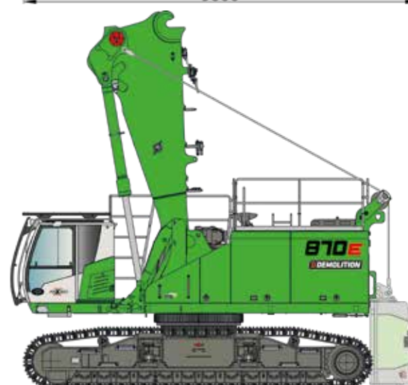
SELBST-MONTAGE-SYSTEM FÜR BALLAST-ABLAGE/AUFNAHME
